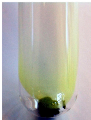
3. ábra: Kén jelenlétének kimutatása hevítéssel Forrás: LAKITS 2023: 40.
