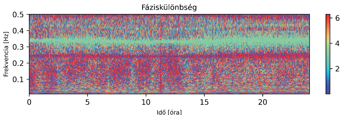
12. ábra A híd negyedelőpontjaiban elhelyezett GNSS-vevők (SAT01 és SAT09) magassági idősorainak fáziskülönbsége radiánban (2024. április 21.)
