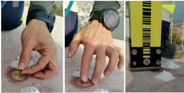
9. ábra. Szintezőléccel felállítása egy M mellvédponton.
