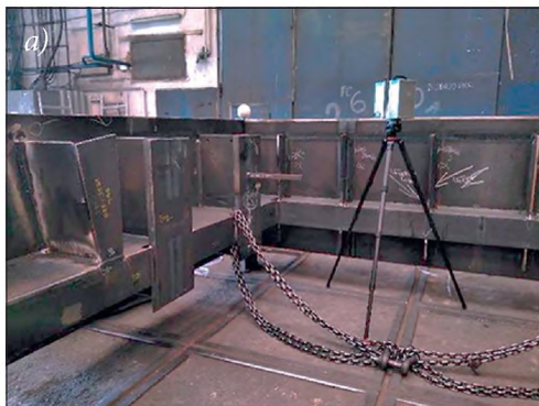
5. ábra. a) A híd pilonszegmensének lézerszkennelése, b) a pontfelhő értékelése Forrás: Somogyi et al. 2022
