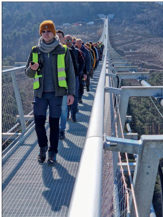
5. ábra. A híd gyalogosdinamikai próbaterhelése Forrás: BME Hidak és Szerkezetek Tanszék
