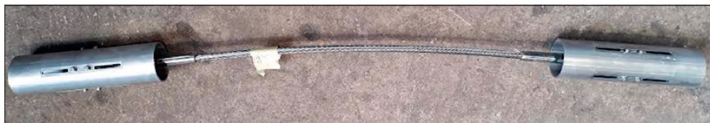
7. ábra. Legyártott és összeszerelt csillapítóelem Forrás: BME Hidak és Szerkezetek Tanszék
