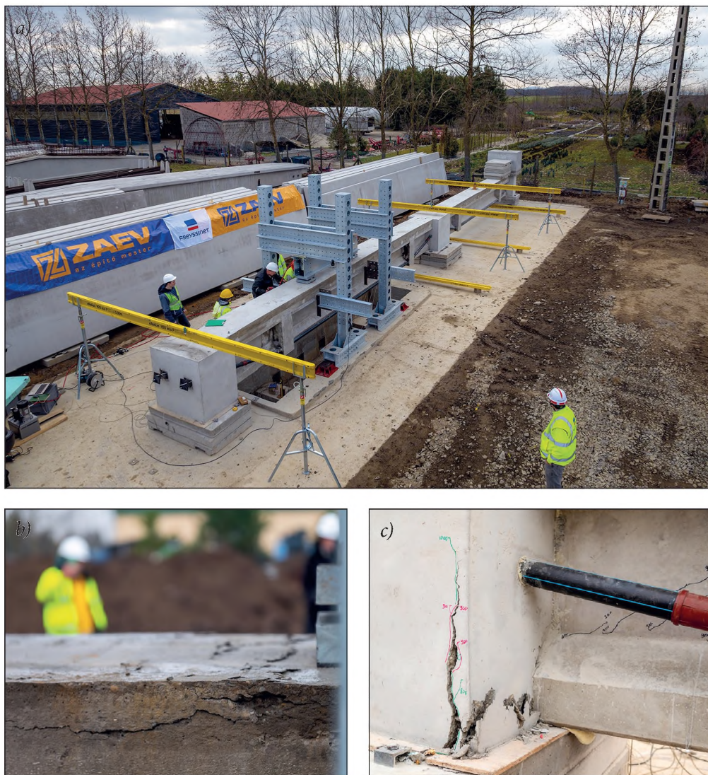
7. ábra. a) A prototípus szerkezet terheléses vizsgálata, b–c) a jellemző tönkremeneteli zónák Forrás: ZÁÉV (Hartmann Péter), Kovács Tamás
