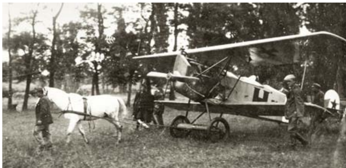
4. ÁBRA. A kétüléses H.02-es lajstromszámú Fokker D.VII (MAG) repülőgép leszerelt motorburkoló lemezekkel, így látható a 200 LE-s Daimler-motor (Forrás: Winkler Aero Archiv)
