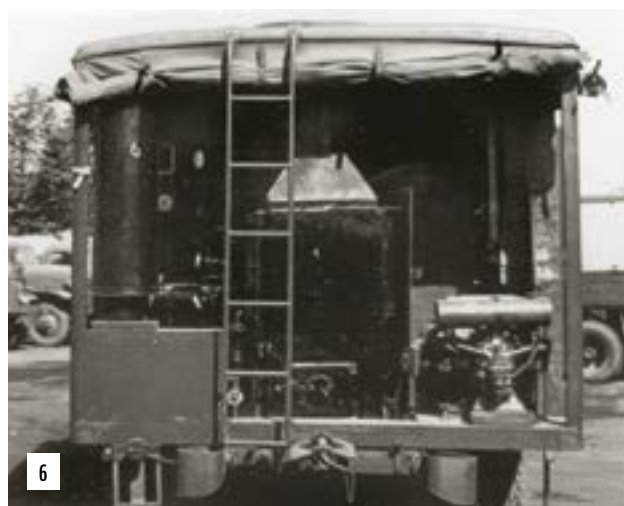
7. ÁBRA. Csepel D-350 forrólevegős és gőzös gázmentesítő gépkocsi [2]
