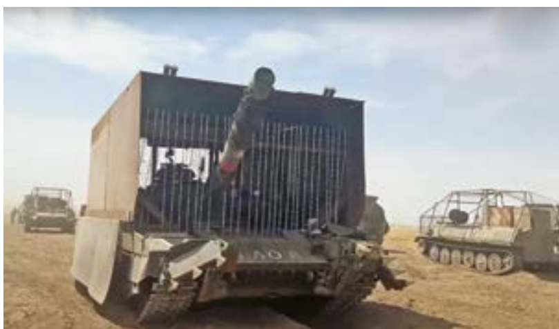
7. ÁBRA. Orosz T-80 teknős tank, a drónok ellen speciálisan felszerelve és megerősítve. Ugyan nem kilőhetetlen, de a hagyományos eszközöknél jobb a túlélőképessége (Forrás: Orosz Védelmi Minisztérium)
