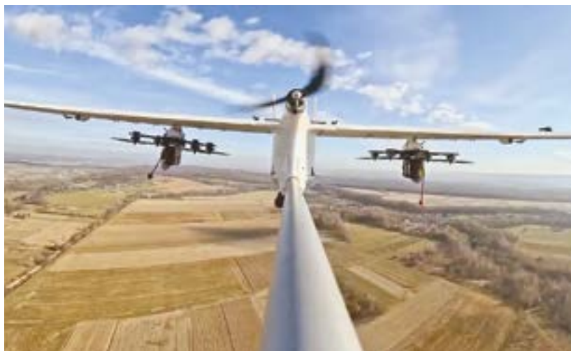
5. ÁBRA. Az ukrán Dovbus T10 merev szárnyú UAV drónanyahajóként FPV eszközöket szállít [16]
