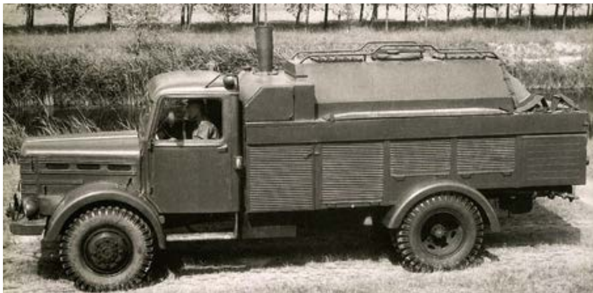
8. ÁBRA. FMG-67 folyadékfosztó gépkocsi terepmentesítés közben. Az első típus, amely komplex vegyi mentesítési feladatok ellátására volt alkalmas [3]
