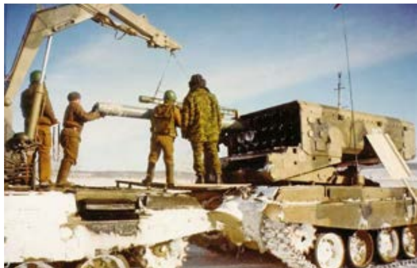
4. ÁBRA. TOSz-1A nehéz lángrészóró töltése TzM-T páncélozott szállító-töltő járművel [6]
