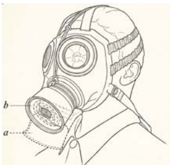
4. ÁBRA. 18M gázálc illusztrációja. A: készleteti (tárolási) állapotban (a gázálc és a szűrőbetét egy zsinórral összekötve), B: védelmi helyzetben (a szűrőbetét a gázálccal összeszerelve) [10]
