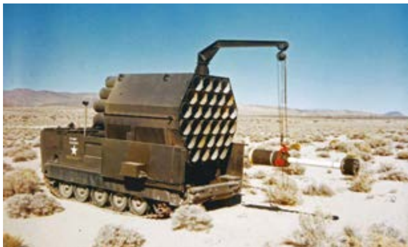
7. ÁBRA. Az amerikai SLU-FAE projektben kifejlesztett, termobárikus rakétákat alkalmazó átjárányító rakétarendszer indító harcjárműve [11]
