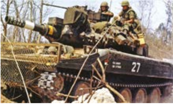
11. ÁBRA. A 4. páncélosfelderítő-ezred egyik Sheridanje Vietnámban, 1969 decemberében. Jól látható a jármű elején rögzített, RPG elleni rács, illetve a torony oldalán elhelyezett löszeres rakaszok és egyéb felszerelések (Forrás: Wikimedia)
