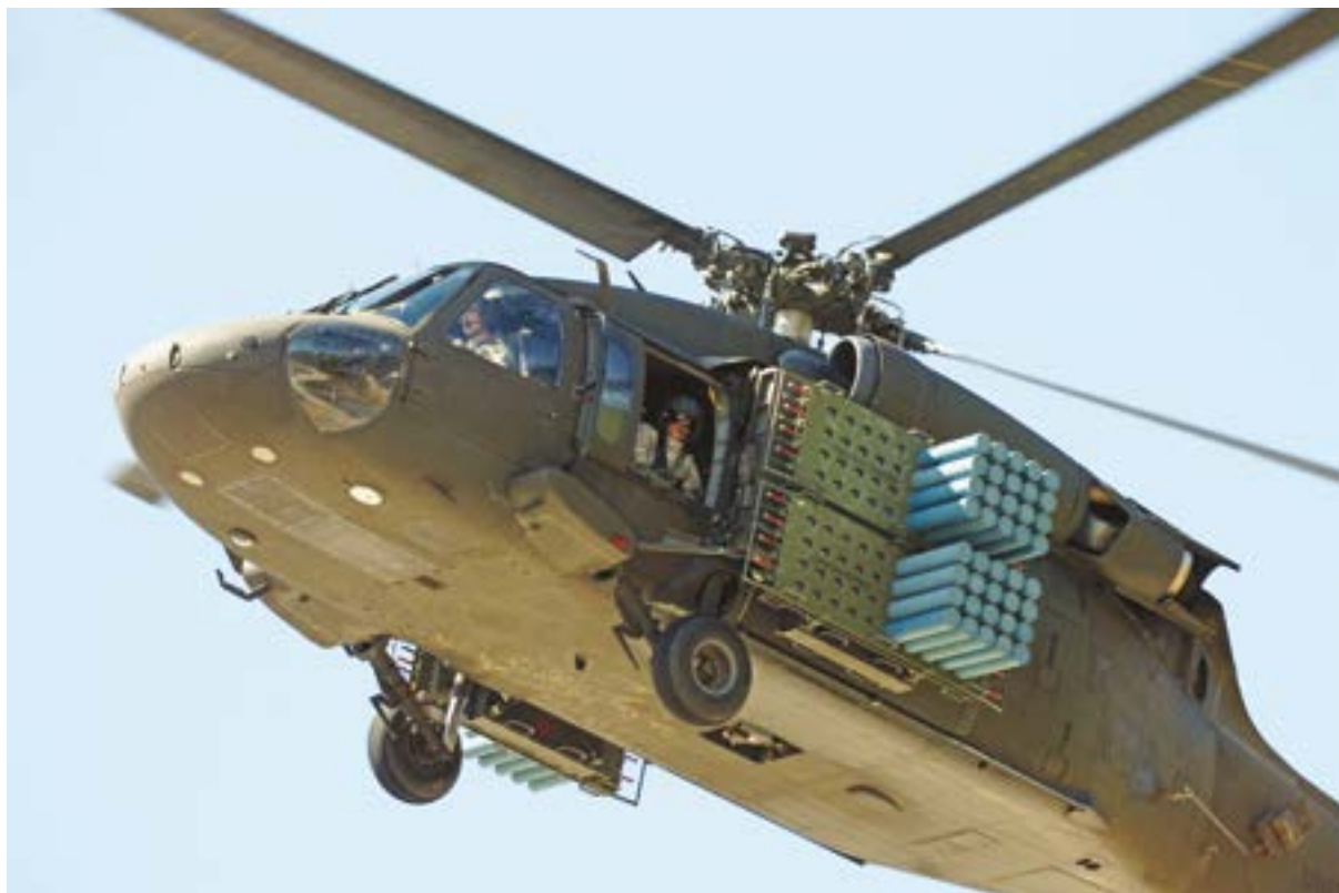
2. ÁBRA. UH-60 Black Hawk helikopterre szerelt M-139 Volcano aknatelepítő rendszer. A fotó az amerikai 2. csapatrepülő-dandár 2012-es dél-koreai hadgyakorlatán készült (Fotó: U.S. Army)
