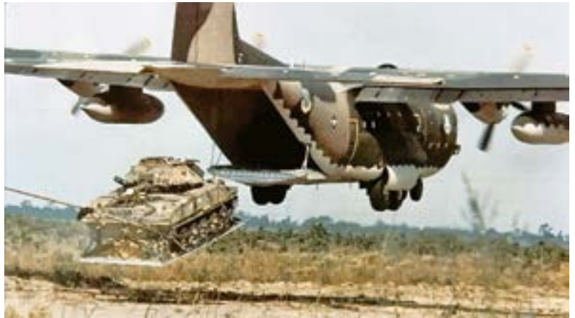
13. ÁBRA. Sheridan ledobása a LAPES-módszerrel egy C-130E szállító repülőgépről (Forrás: Wikimedia)
