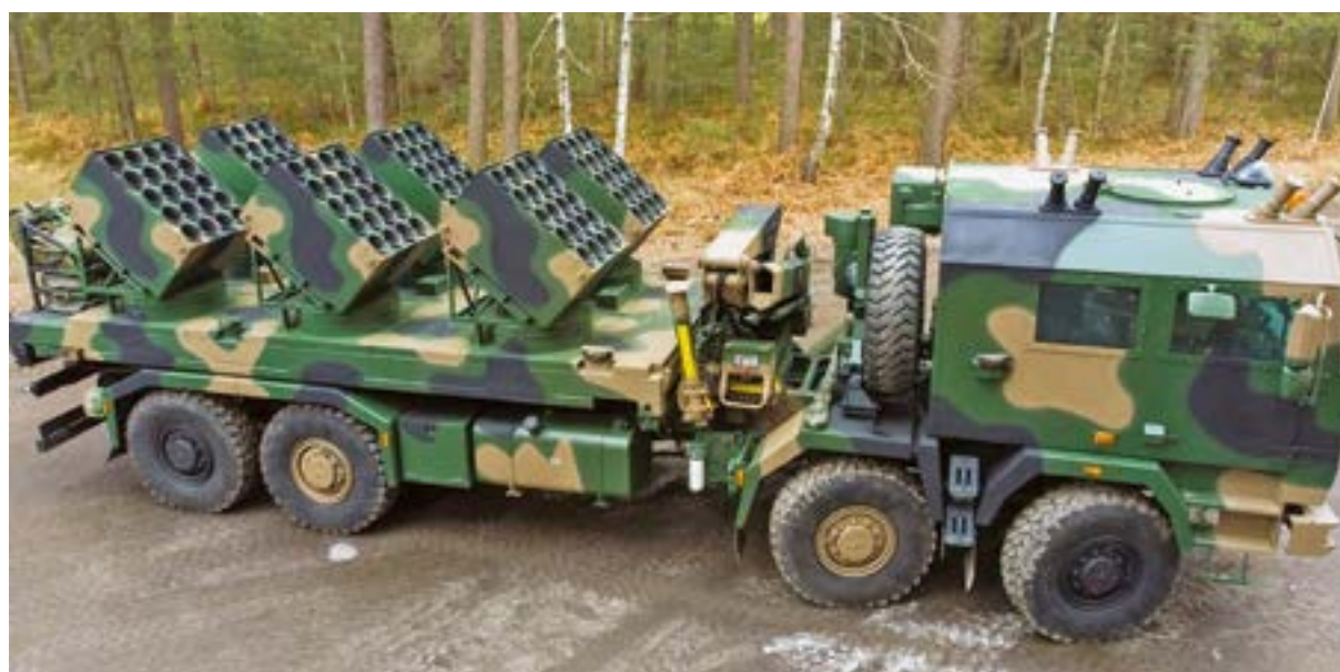
10. ÁBRA. Lengyel Baobab-K műszaki aknaszóró rendszer [20]
