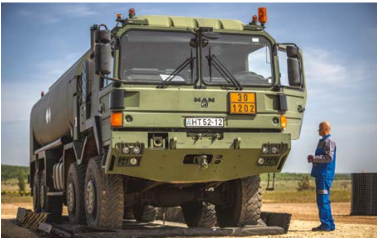
16. ÁBRA. MAN HX 32.440 18 m 3 -es üzemanyag-szállító és -töltő gépkocsi (Forrás: HM Zrínyi Nkft. / honvedelem.hu / Szováthy Kinga)
