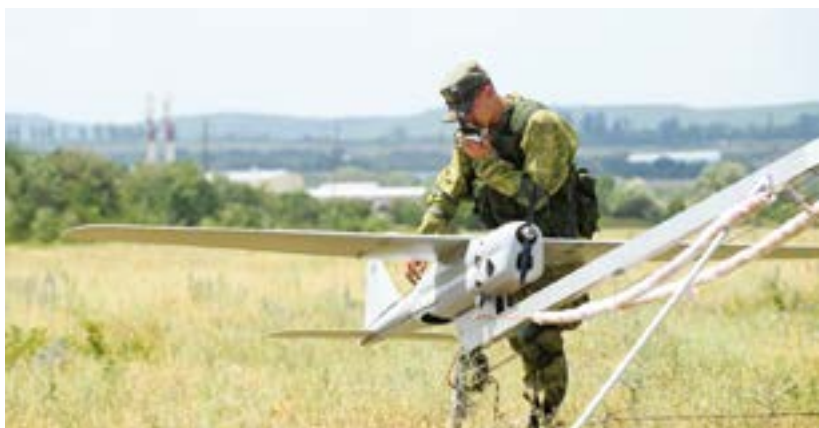
7. ÁBRA. Orlan-10 felderítő UAV indítása katapulttal [25]
