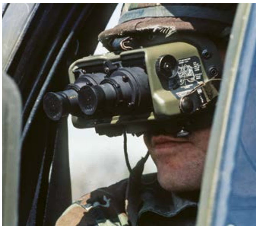
3. ÁBRA. Az AN/PVS-5A típusú éjjellátó szemüveg (a lencsevédők felhelyezett állapotában) [13]
