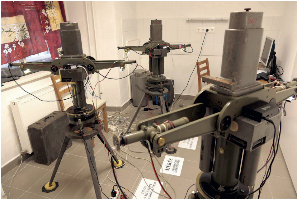
8. ábra. Auterbal-ingák a BME Általános- és Felsőgeodézia Tanszékének gravitációs laboratóriumában (fotó: Völgyesi Lajos)
