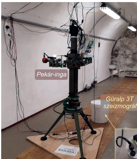
6. ábra. EPF-mérés Eötvös–Pekár-ingával a HUN-REN Wigner Fizikai Kutatóközpont Jánossy Földalatti Kutatási Laboratóriumában, 30 méteres mélységben (Völgyesi et al., 2023)
