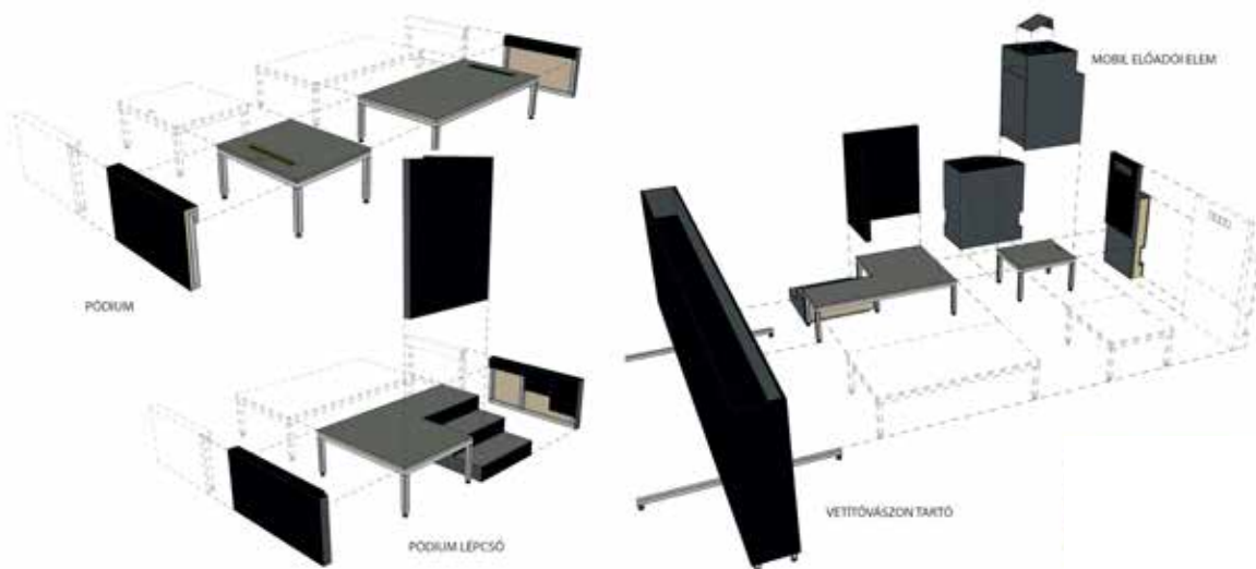
24. kép Összeállítási séma az elnöki pulpitushoz, 2024. (Forrás: DMSC)
