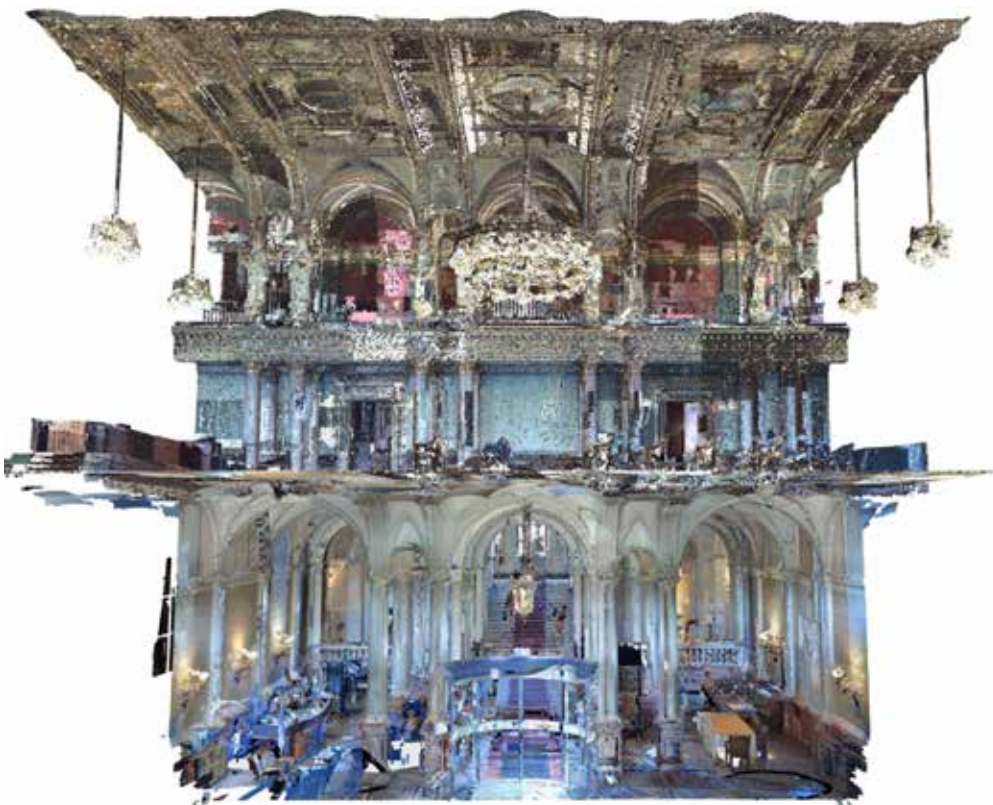
12. kép 3D pontfelhő állományból generált metszet (Előcsarnok, Díszterem), 2021. (Forrás: Közti Zrt.)
