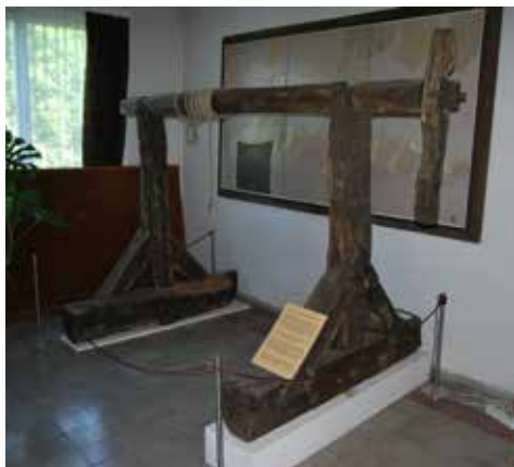
5. kép A füzéri vár kútjának feltárt 17. századi felvonószerkezete. (Herman Ottó Múzeum, Miskolc) (Fotó: Gál Viktor felvétele)
