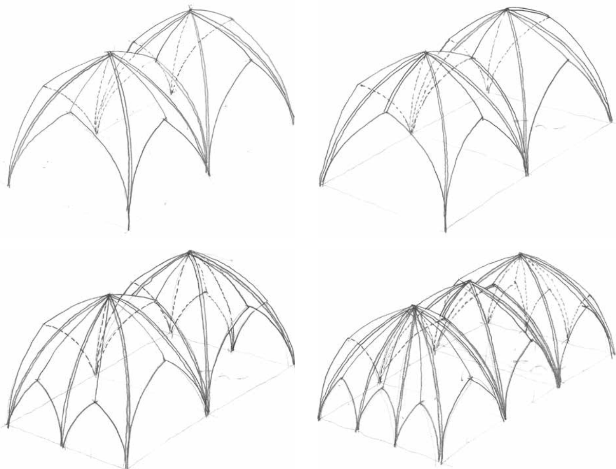
3. kép 1:1,5 oldalhossz arányú középkori terek lefedése keresztboltozattal (Sopron, Új utca 11. zsinagóga), keresztboltozat gerincbordával (Miltenberg, zsinagóga), egymással szembe fordított ötsüveges boltozatokkal és a polygonális szentélyzáródásból átvett, beforduló boltsüvegekkel. (Sopron, Ó-Zsinagóga) (Rajz: Józsa Dávid, Veöreös András)
