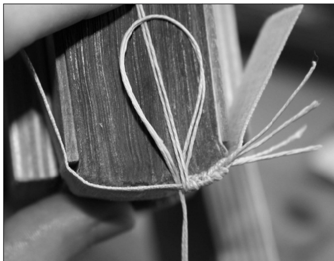
33. kép Új ormszegő készítése
