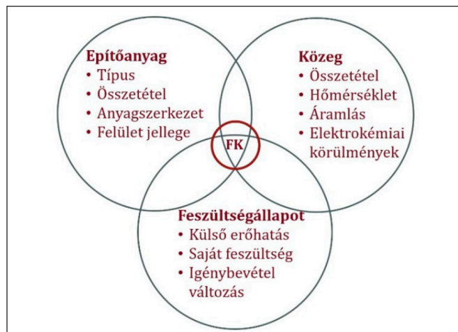
2. ábra: A feszültségkorrózió kialakulásának feltételei (Hickling, 1982)
