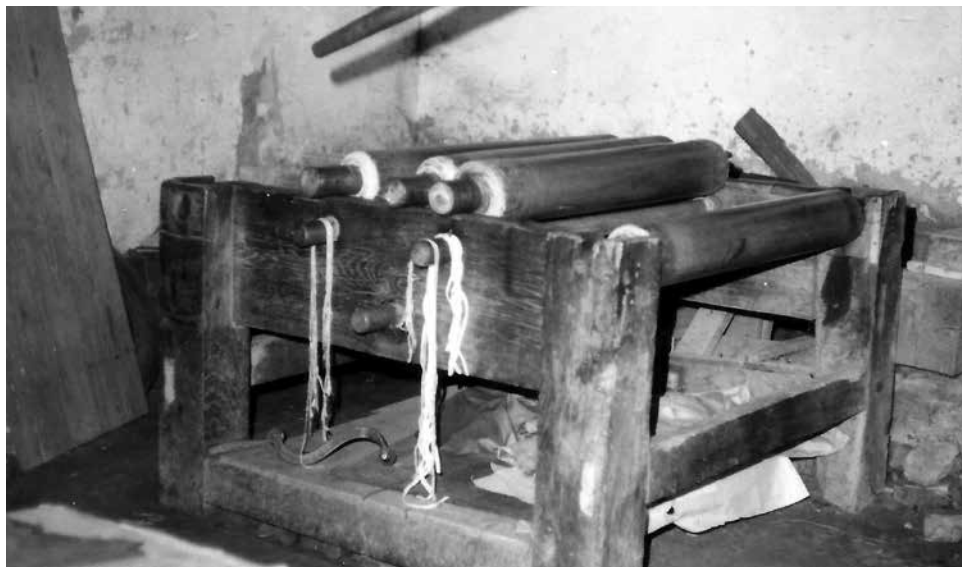
26. A mángorolt textilá átcsevézésére, kisímitására, feszítésére szolgáló ácsszerkezetű munkapad
