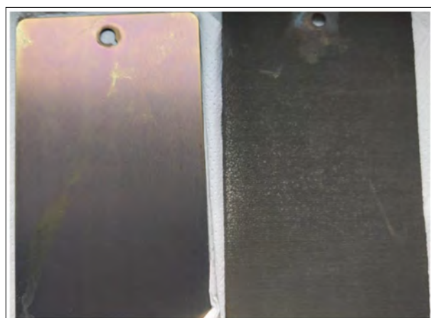
8. ábra. 1,5 g/L molibdénadalékos foszfátzóval készített mintalemezek; balra Q-panel, jobbra öntöttvas mintalemez
