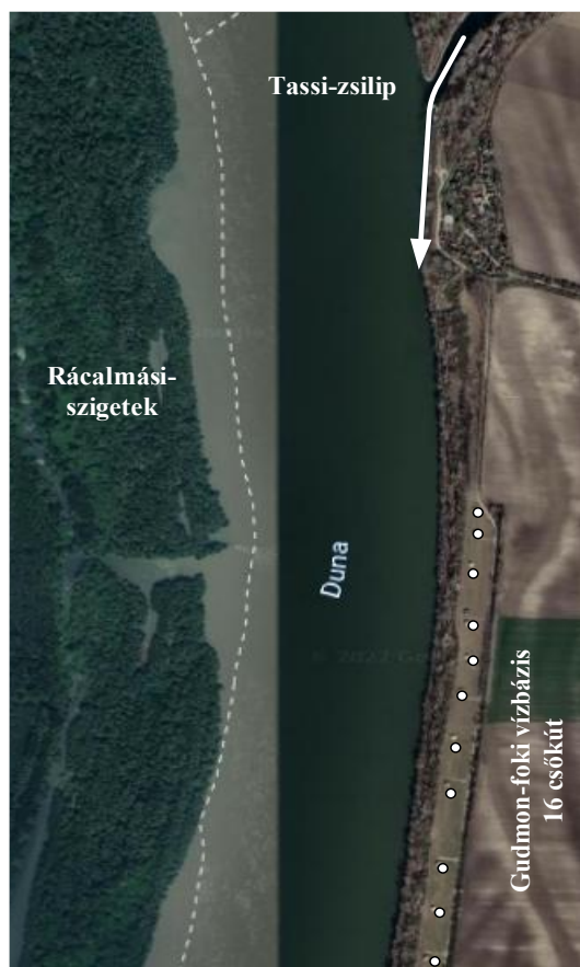
13. ábra. A Gudmon-foki vízvezeték elrendezése (saját ábra Google térkép felhasználásával)
