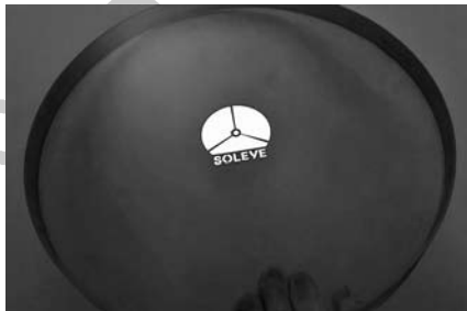
Soleye 300 Violet mirror kollimációs markerrel, amit Kurucz János gőzölt a tükör közepére
