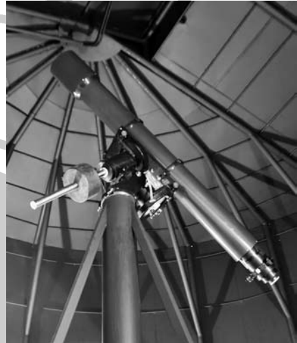
Új, magyar gyártású 150/1800-as triplétt refraktor (Unioptik a kupolában)
