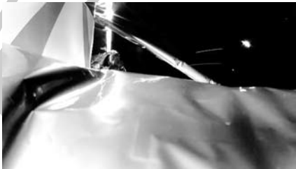
A szonda külső burkolatán keletkezett deformációk (Astrobotic Technology, Spacenews.com)
