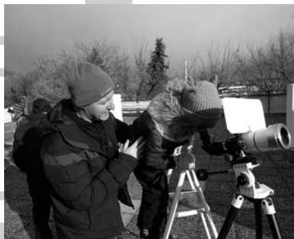
A TS 60/360 mm-es refraktor energiacsökkentő üvegszűrővel (ERF) SW AZ-Pronto állványon a Polaris teraszán
