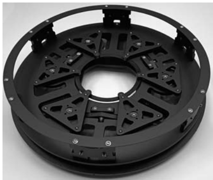
Az elkészült főtükörtartó, blende gyűrűvel
