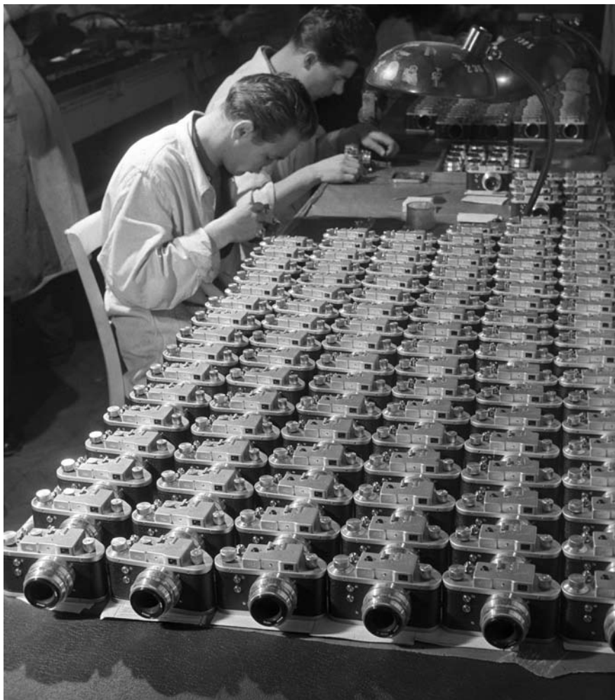
Volt egyszer egy fényképezőgép-gyártásunk... Műszerészek az utolsó munkafázisokat végzik a Mometta Junior gépek egy szériáján a Magyar Optikai Művekben (1958). MTI Fotó: Lajos György
