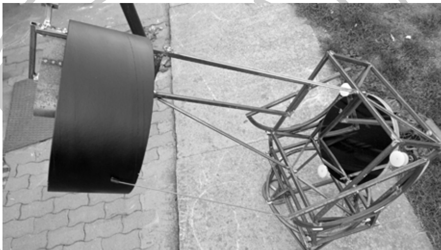
A kihuzattal átellenes oldalon egy gépkocsi elvágott rádióantennája tartja az árnyékoló papírgyűrűt
