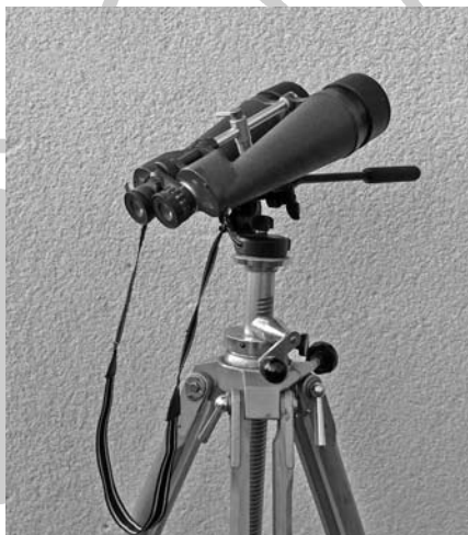
Mostanában szívesen észlelek ezzel a 20x80-as Vixen-binokulárral. Az állvány hihetetlenül masszív, még az NDK-s időkben készült. A panorámafejt megfelelő magasságba emelhető, ha a változó nincs a zenit közelében, akkor nagyon kényelmes a betekintés
