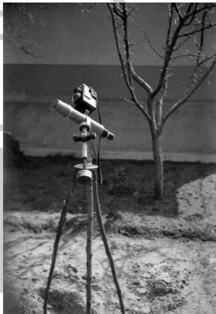
50/250-es refraktorom fusiban készült parallaktikus mechanikáján, Ljubityel-2 fényképezőgéppel a hátán. Nem volt ez apokromát, még csak akromát se, csak egyszerű kromát: erősen színező egytagú lencse bármilyen bevonat nélkül
