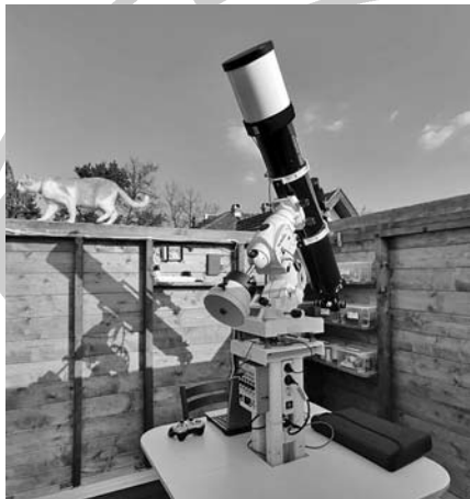
Bánfalvy Zoltán G23 – Vulpecula Observatóriuma, benne a 150/1200 refraktorral. Az érzékelő egy ASI 178MM. Az észlelőt sokszor róla képen is látható Rosetta nevű macska
