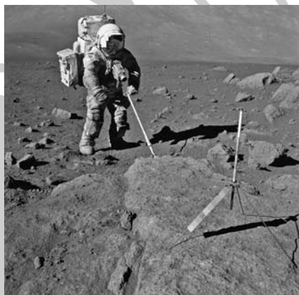
12. ábra. Harrison Schmitt mintát vesz egy sziklatömbből a második holdautós út (EVA-2) során, az 5-ös számú mintavételi helyen, a Camelot-kráter közelében. Az űruhra nagy felületen beszennyeződött a tapadós holdporral. Az előtérben a függőleges irányt jelző gnómon és színskálátábla látszik (NASA Apollo-17 misszió, AS17-145-22157)
