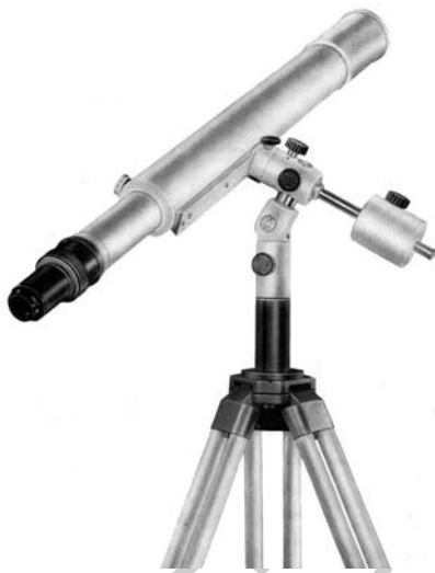
„Ös-Telementor” a hatvanas évekből. A parallaktikus mechanika rendkívül egyszerű, finommozgatás nélküli. A háromláb már megelőlegzi a Telementor világát. Az objektív még mindig AS rendszerű
