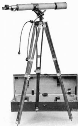
Hordozható, 60/850-es Zeiss Asegur kisrefraktor földi és csillagászati használatra, az 1920-as évekből
