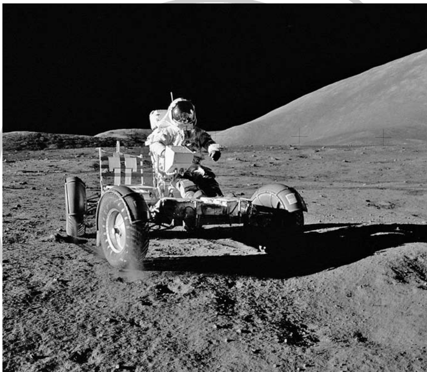
10. ábra. Eugene Cernan próbaúton a holdautóval (LRV) a Taurus–Littrow leszállóhelyen. A holdautóra még nincs feltéve a parabolaantenna és a fedélzeti kamera. Az LRV kerekei felverik a holdport, de a sárvédők meggátolják a por felcsapódását (NASA Apollo-17, fotó: Harrison Schmitt, AS17-147-22526 )
