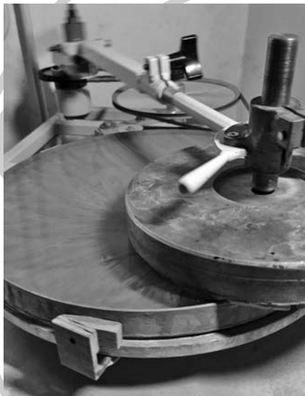
A tükör egy faékkel van rögzítve a géptálcára, ez a kép alján balra látható. A polírozás akkor a leghatékonyabb, ha a szuroktárcsa nyomán alig látható, áttetsző csík jelzi a polírozóanyag jelenlétét
