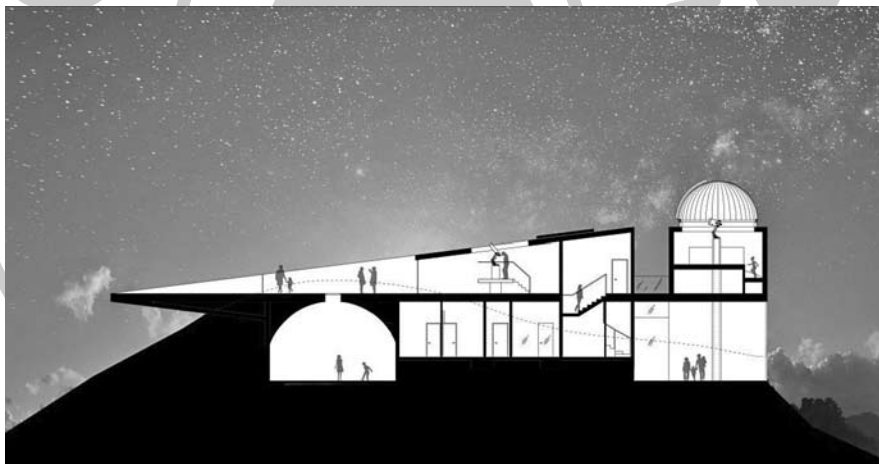
A csillagvizsgáló metszete. Jól látható az ék alakú „űrhajó” szerkezete. A kupolától balra egy letölthető tetős észlelőhelyiségben kap helyet a naptávcső, a kisebb műszereket a csillagos égboltra „nyíló”, a hegytetőről kinyúló észlelőteraszon helyezhetik el – akár a látogatók is (kép: Tsolakis Architects)
