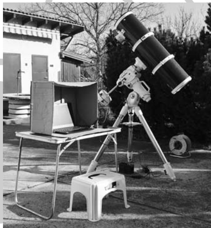
A szerző 200/1000-es Newton-távcsöve SkyWatcher EQ6-R mechanikán, a ZWO ASI 183MM Pro kamerával felszerelve. A vezérlést és képfeldolgozást laptop végzi, amely a párasodás megelőzésére egy dobozba került
