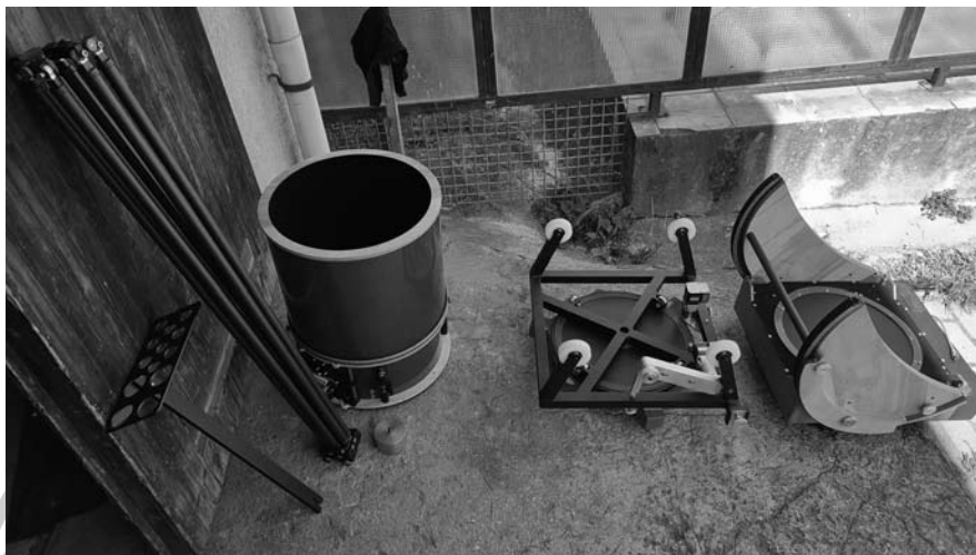
A távcső darabokban, rövid idő alatt összeállítható, szétszedhető, így pakolni, hordozni is könnyű
