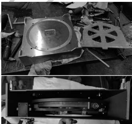
A főtükör foglalata a „Rocker box” készítése közben
