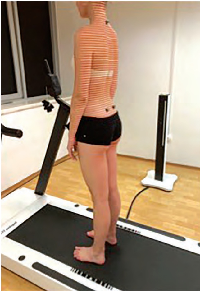
5. ábra: | DIERS rendszer kalibrálása a markerek alapján
