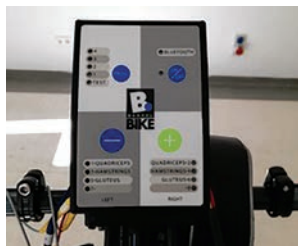
4. kép | A BerkelBike kormányra szerelt sokcsatornás izomingerlő készüléke
