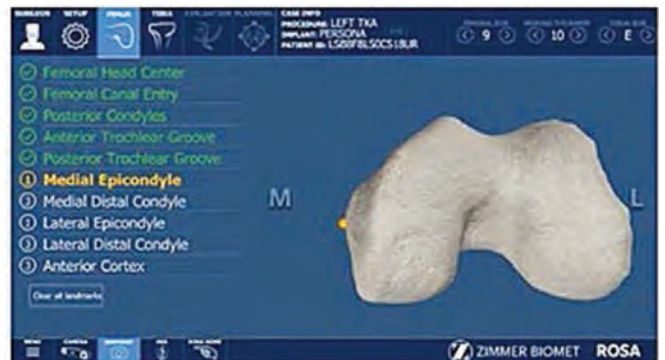
3. ábra | Csontos referencia pont (sárga pont és felirat) betáplálása a műtét elején a ROSA™ robot rendszerbe a csontra helyezett érzékelővel
