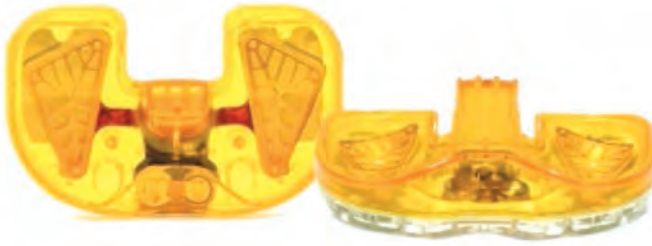
5. ábra | Zimmer NEXGEN™ implantátumhoz használható polietilén betétet imitáló Verasense™ szenzor
