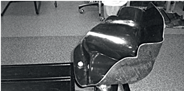
2. ábra | Magasabb gerincsérülés esetén használt magasított speciális beülő modul
