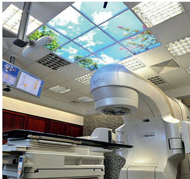
1. ábra | A Varian TrueBeam lineáris gyorsító – a kezelésekhez igazodóan – különböző energiájú foton- és elektronsugárzás előállítására képes
