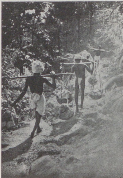
4. ábra. Bauxit leszállítása Bagru hegyről. Egy-egy kuli terhelése 40—42 kg.
