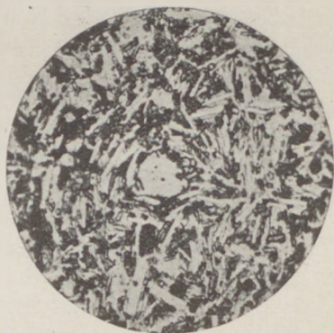
3. ábra. Badacsonyi bazalt mikroszkópi képe kb. 80\times a fehér és fekete foltok különböző ásványok.
