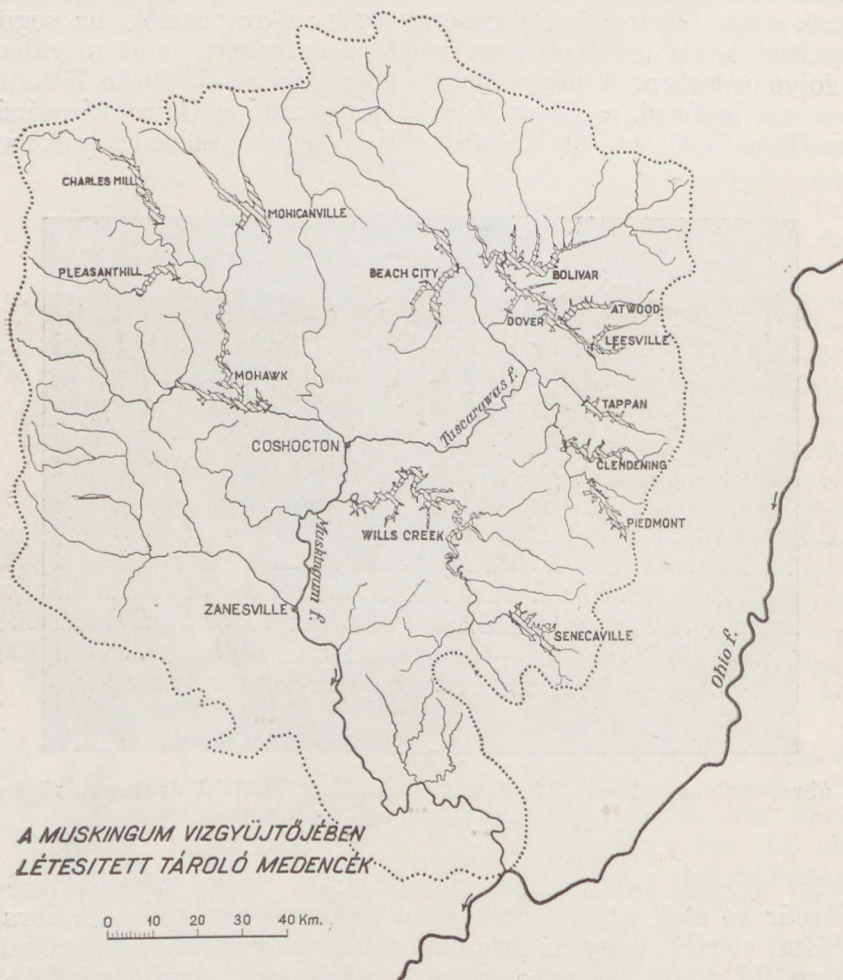
7. ábra. Heves esőzések vizének felfogására szolgáló tároló medencék az Ohio egyik mellékfolyóján.
