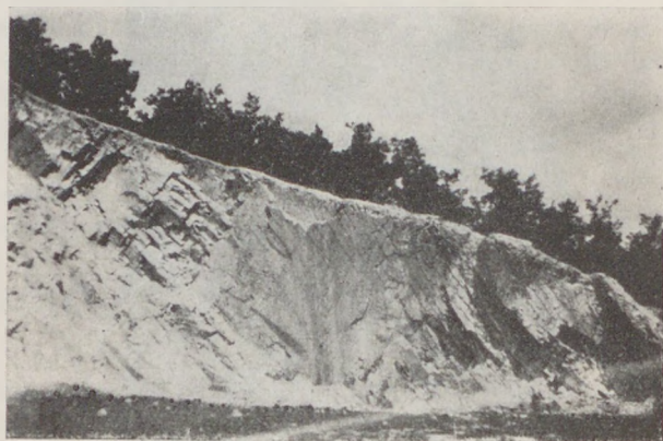
2. ábra. Hármás elválás a Fehér-bányában, az elváló darabok rombusz alakú lemezek.
