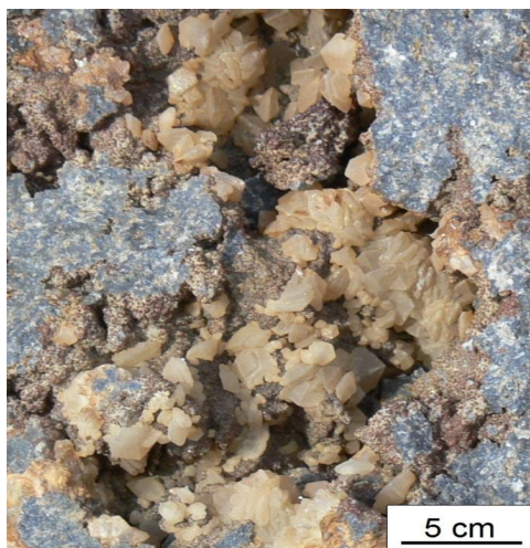
6-7. kép: romboédres kalcit és sziderit ikrek a tállyai andezit üregeiben Pictures 6-7. Twinned calcites and siderites in holes of Tállya andesites
