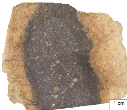
9. kép: a nedves tufákkal való érintkezés szegélyein az oszlopok elvégződéseinél széles bontott sáv alakult ki a bontott andezitben, amelynek anyaga tufaszerű és agyagosodott Picture 9. Formation of broad decomposed zone in dissociated andesite with tufa-like and clay structures
