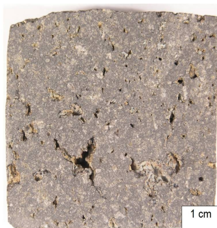
4-5. kép: a tállyai andezit tömött szövetű és hólyagtüreges változatainak felületi képe Pictures 4-5. Surface views of andesite varieties with dense and loose textures from Tállya
