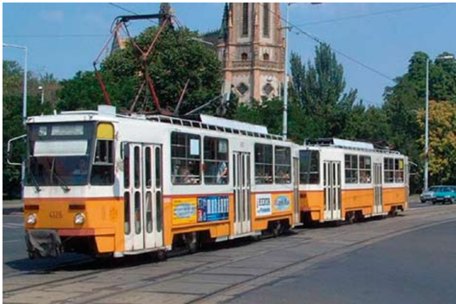
1. ábra: A Tátra T5C5 közúti vasúti motorkocsi
