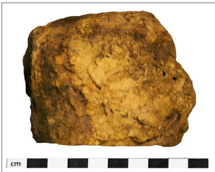
1. ábra. Dédestapolcsány – Verebce-bérc lelőhely 9. számú depójából származó 27-es leltári számú tömörített vastuskó, amit a kísérlethez használtam fel alapanyagként
