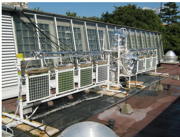
1. ábra: Nagylaboratóriumi fotobioreaktor, szabadba telepített, természetes megvilágítással
