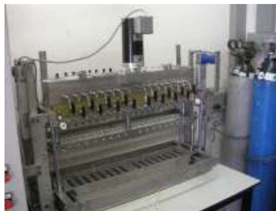
6. ábra Dead-end szűrési elven alapuló tesztberendezés
