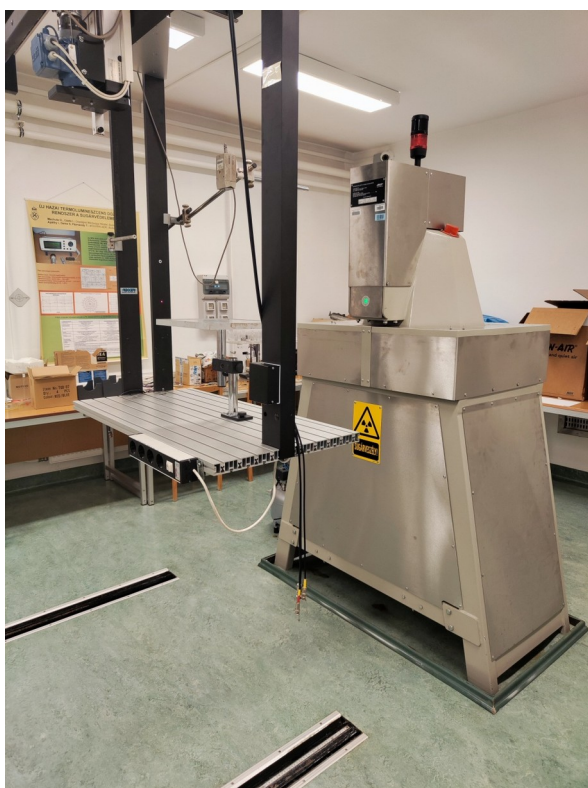
12. ábra. Műszerhitelesítő Gamma besugárzó
