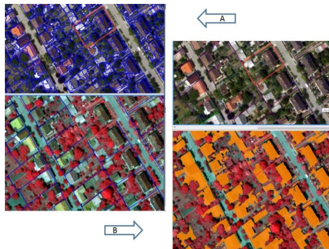
2. ábra Elemzések szub-objektum szinten: A) földrészleten belüli szegmentálás eredménye, B) földrészleten belüli mesterséges területek osztályozásának az eredménye.
