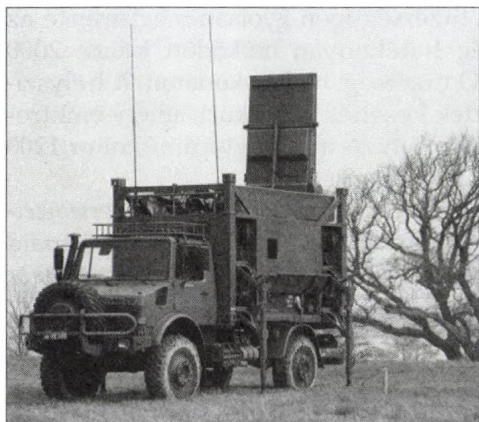
2. kép. Az ARTHUR 5 tonnás szabvány terepjáróra szerelt változata
