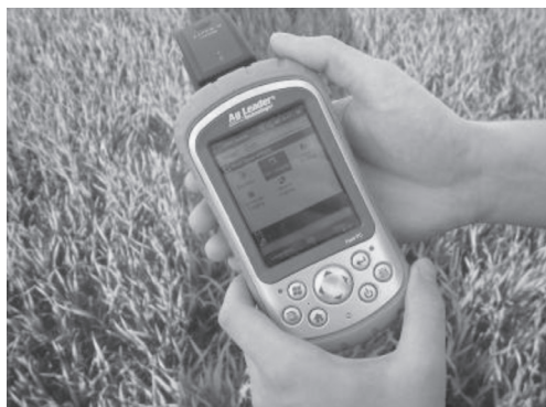
3. ábra: AgLeader típusú marokszámítógép GPS-szel kombinálva Figure 3: Minicomputer (AgLeader) combined with GPS
