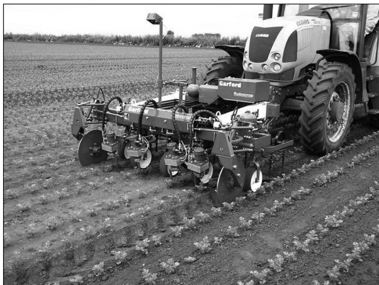
6. ábra: Zellert kapáló gép egy öko-gazdaságban (Fotó:Borsiczky I.)
