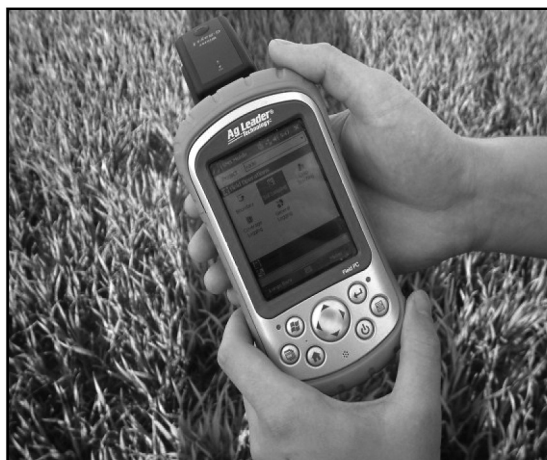
1. ábra: GPS vevőkészülékkel kombinált terepi marokszámítógép Fig.1.: Field computer combined with a GPS instrument
