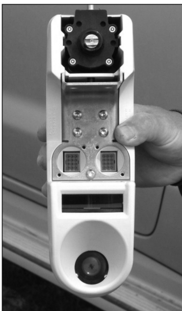
2. ábra: Weed Seeker (gyomvadász) szenzor+szórófej Fig.: 2.: Weed Seeker (sensor + nozzle)
