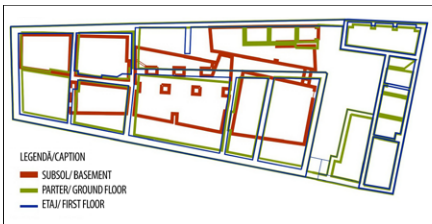
■ Fig. 12. Suprapunerea pereților Subsolv-Parter-Etaj. © Progir Structural
