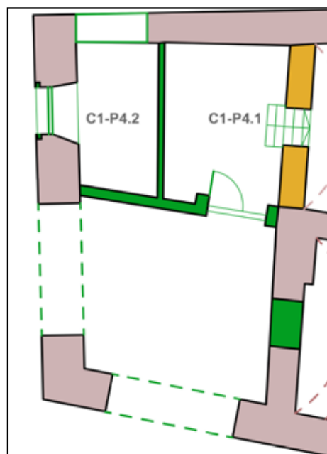
■ Fig. 24. Încăperile de la parter al căror planșeu, presupus boltit, s-a înlocuit cu un planșeu nou din grinzi de lemn alăturate, în prezent peste pasaj și încăperile alăturate. © Progir Structural ■ Fig. 24. The ground floor rooms, where the presumed vaulted slab was replaced with a new timber joist floor slab, currently over the passageway and the adjoining rooms. © Progir Structural
