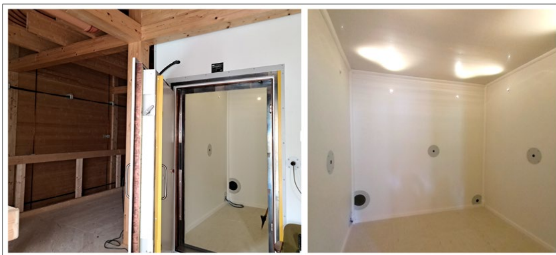
4. ábra. A Mágneses Nulltér Laboratórium központi, mu-metallal burkolt kamrája, amelyet a német Vacuumschmelze GmbH készített
