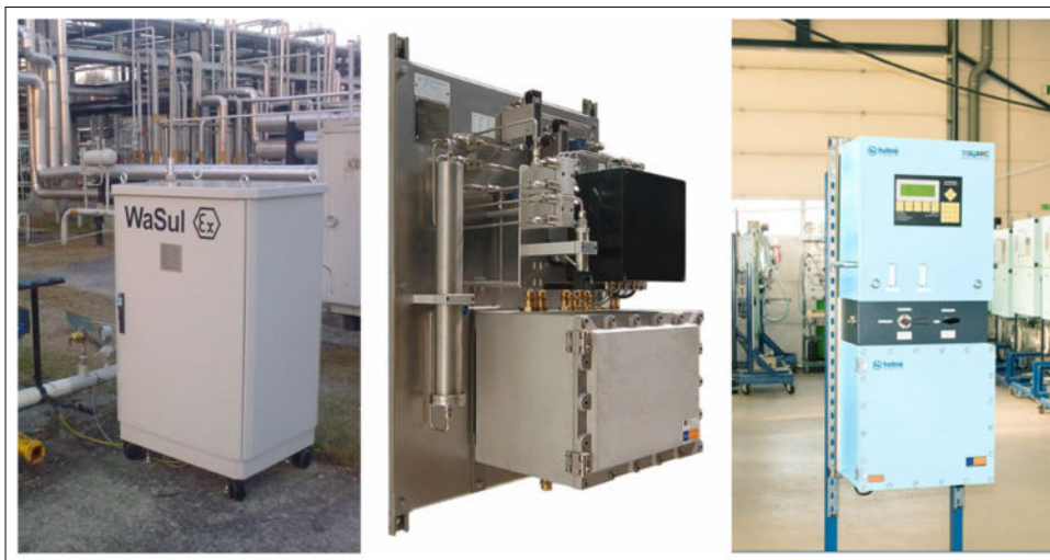
2. ábra. Az általunk fejlesztett műszerek különböző robbanásbiztos változatai az olaj- és gázipar számára
