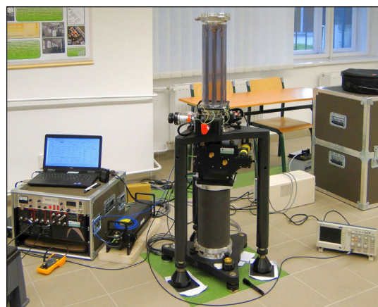
3. ábra. Mérés az FG5X típusú abszolút graviméterrel az Oltay-féle ponton
