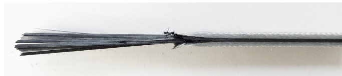
15. ábra: Egy ferde végű fülekkel ellátott próbatest jellemző töretképe (oldalnézet)
